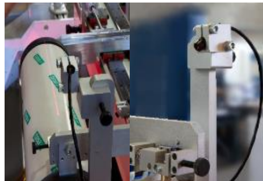
Láser para el ajuste del prerregistro
